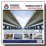
Le Minéralisant B est une solution de polycristaux de silicium. Il pénètre par capillarité dans les bétons, où il provoque par réaction chimique la cristallisation des chaux libres et la formation de silice dans les pores. Cette réaction est appelée la minéralisation. Les bétons ainsi traités deviennent imperméables à l'eau, et plus résistants aux attaques extérieures (sels de déverglaçage, produits d'entretien, nettoyage à la pression, gel, agressions atmosphériques, etc.).
